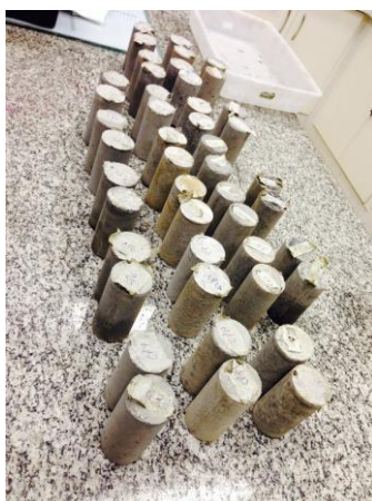
Figura 6 – Corpos de prova - argamassa (AUTORES (2014))
