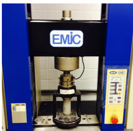
Figura 7 – Rompimento corpo de prova – argamassa (AUTORES (2014))
