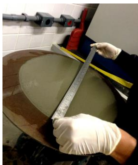
Figura 4 – Ensaio realizado: Mesa de consistência (AUTORES (2014))
